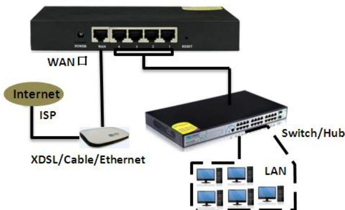
图 2-3 进取™ 510 连接示意图
