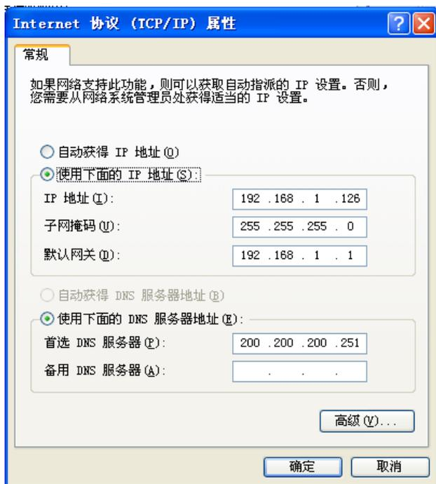
图 A-2 TCP/IP 属性 IP 地址配置窗口
