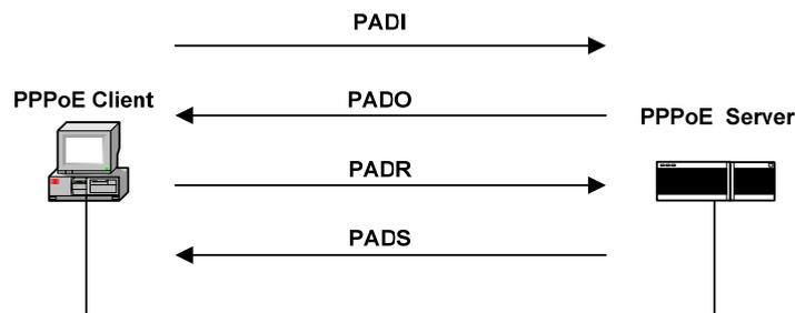
图 8-9 Discovery 阶段的基本工作流程
