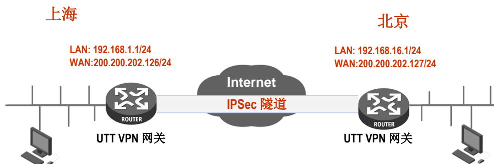
图 12-20 网关到网关拓扑图
