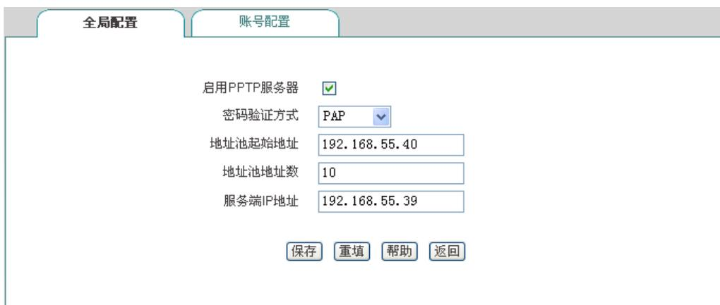
图 13-7 PPTP 服务端配置 1
