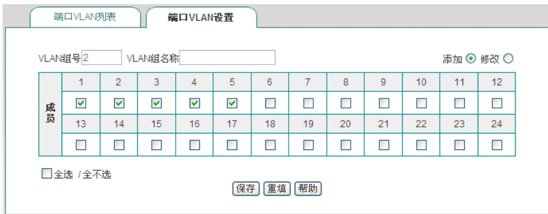
图 8-4 端口 VLAN 设置
