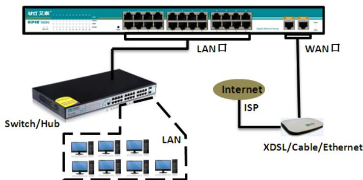
图 2-2 商睿™ 3520G 网络连接示意图
