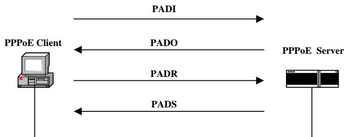
图 9-9 Discovery 阶段的基本工作流程
