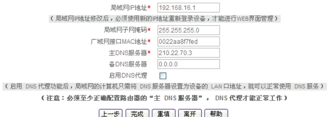
图 4-7 动态 IP 接入配置
