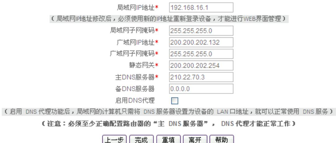
图 4-5 固定 IP 接入配置
